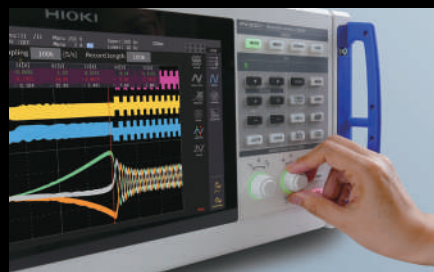
通過直觀的旋鈕操作，可以調整波形的顯示位置、觸發以及諧波次數
