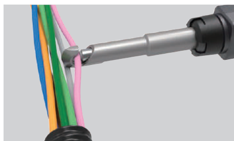
開いた先端を CAN バスに引っ掛ける
