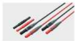
延長線 L4931 香蕉頭-香蕉頭(紅/黑 × 各1)-L9438-50或 L1000 延長用、線長 1.5 m、帶耦合連接器 CAT IV 600 V、CAT III 1000 V
