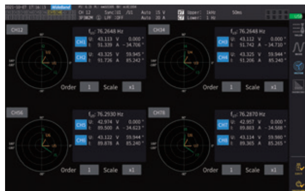
以 3P3W2M 接線的 4 變流器・馬達的向量分析示例
