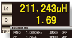
L,Q顯示介面(1kHz, CC1mA測量)
