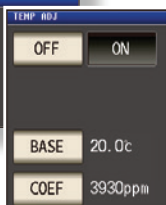
溫度補償設置 (放大)
