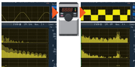
變頻器輸入輸出，同步各自的基波
