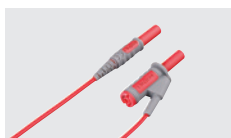
轉接線 L1021-01 香蕉頭分叉-香蕉頭(紅 × 各1) 電壓輸入分叉用、線長 0.5 m CAT IV 600 V、CAT III 1000 V
