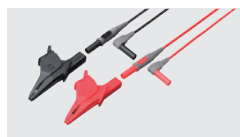
連接線 L9257 香蕉頭-香蕉頭(紅/黑 × 各1)、帶鱷魚夾 線長 1.2 m CAT IV 600 V、CAT III 1000 V
