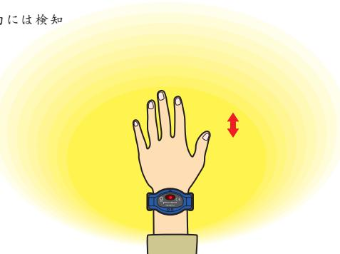
手のひら方向は上方向にくらべて検知距離が短くなる
