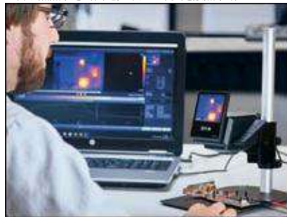
透過 USB 與電腦連線，FLIR Tools+ 進行分析
