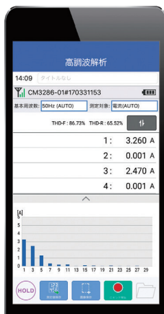
最多 30 次的諧波分析 確認電源品質
