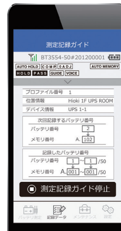
以語音指引 UPS 點檢時的測量順序
