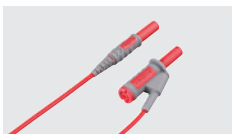
轉接線 L1021-01 香蕉頭分叉-香蕉頭(紅 × 各 1) 電壓輸入分叉用、線長 0.5 m CAT IV 600 V、CAT III 1000 V
