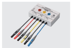
接線轉換器 PW9000 三相 3 線(3P3W3M)接線時， 可將連接的電壓線從 6 根縮減到 3 根 CAT IV 600 V、CAT III 1000 V
