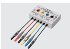
接線轉換器 PW9001 三相 4 線(3P4W)接線時， 可將連接的電壓線從 6 根縮減到 4 根 CAT IV 600 V、CAT III 1000 V
